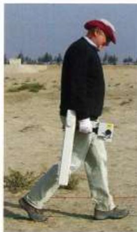
Uso de un magnetómetro en una prospección en Tell el-Borg, Sinaí. Este instrumento permite a los arqueólogos ver estructuras bajo la superficie del suelo.
